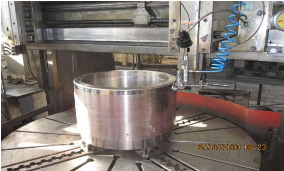
Рисунок 2 - Механическая обработка бандажного кольца с охлаждением зоны резания с помощью вихревой трубки
