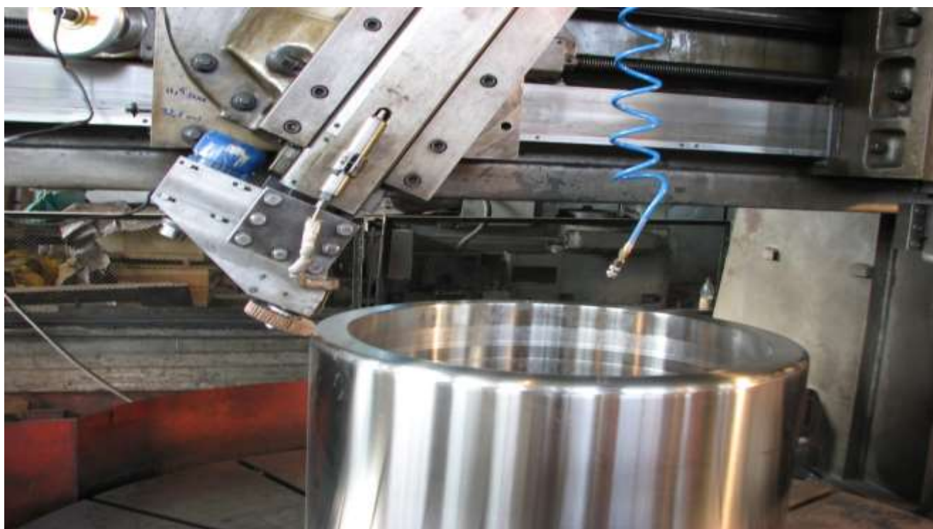
Рисунок 5 - Охлаждение зоны резания при шлифовании бандажного кольца
